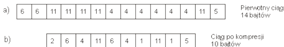
Rys. XV.1. Przykład kompresji metodą RLE. a) Informacja przed kompresją, b) informacja po kompresji
