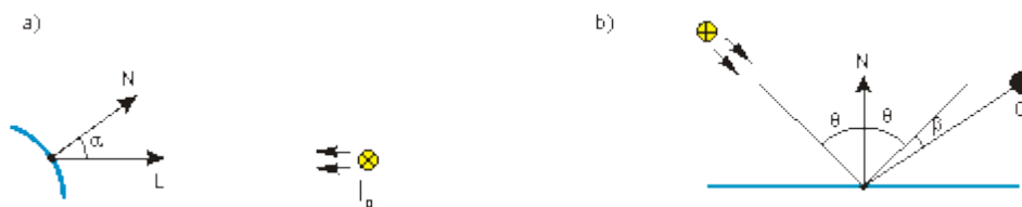
Rys. XI.5. Ilustracja do sposobu obliczania jasności punktu w przestrzeni 3D. a) Wpływ oświetlenia przez punktowe źródło światła, b) efekt odbicia zwierciadlanego
