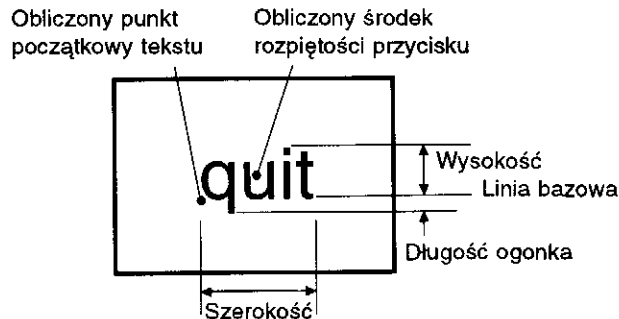
Rys. 2.10. Wymiary tekstu umieszczonego w prostokątnej przycisku i punkty obliczone na podstawie tych wymiarów umożliwiające umieszczenie tekstu pośrodku
